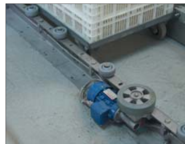
I stedet for traditionelle kæder til fremdrift anvendes drivhjul, der trækkes af elmotorer.
